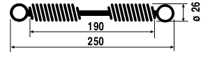
FS 062 Suole 210 mm - Richiamo ceppo freno Rif. Orig. ★ Ø 4,7 210 mm flanges - Brake block return Orig. Ref. ★
