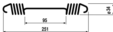
FS 145 Richiamo ceppo freno Post. Rif. Orig. 5010098945 Ø 5 Rear brake block return Orig. Ref. 5010098945
