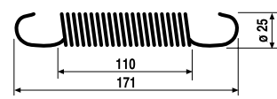
FS 104 Richiamo ceppo freno Rif. Orig. 1599000D Rear brake block return Orig. Ref. 1599000D
