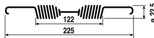
FS 026 Molla richiamo ganasce Ø 3,4 Rif. Orig. 42480056 42480056 Brake shoe return spring Orig. Ref. 42480056
